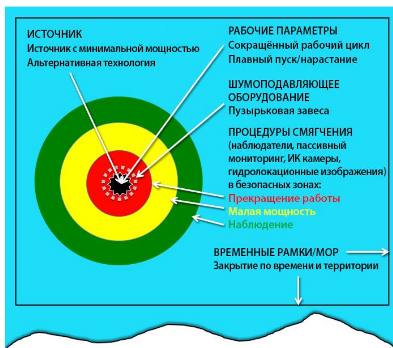
Рисунок 2. Схема вариантов шумоподавления. Горизонтальный вид на океан у кромки льда. Варианты шумоподавления показаны у источника (например, изменение технологии или операций), рядом с источником (например, установка шумоподавляющего оборудования), в зонах мониторинга (например, задействование наблюдателей за морскими млекопитающими, пассивный акустический мониторинг, инфракрасные камеры или системы формирования гидролокационных изображений) и по всей территории (т.е. ограничение операций в определённые сезоны или в пределах морских охраняемых районов (МОР)).
